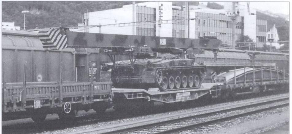
Ein Brückenpanzer 68, verladen auf einem Smmnps-y, Res und Ks (Schutzwagen) in Thun (18.6.98; Foto P. Hürzeler)
